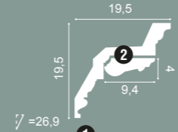
1 C307 + C307A 2 C307A: 7,5 x 4 x 9,4 Duropolymer®
